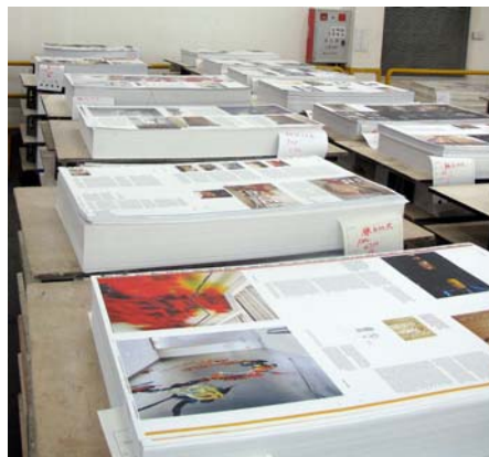
Mehrere Doppelseiten werden auf einem Druckbogen angeordnet
